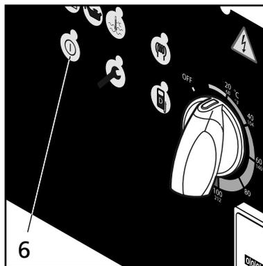
1. Установите переключатель на требуемую температуру. Засветятся 6 световых индикаторов, машина готова к использованию. Если вы хотите работать, используя воду с температурой около 100°C, поверните вращающуюся ручку (черную) на насосе по часовой стрелке до упора.
